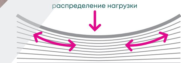
Горизонтальные слои частично перемешанные между собой. За счет этого снижается трение между слоями и обеспечивается однородность наполнителя.
